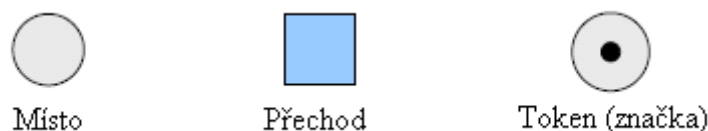
Obr. 3.5: Hlavní modelovací prvky Petriho sítě
